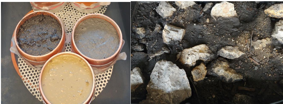
Abbildung 2: Laborversuche mit Schlammsubstrat: links Schüttmethode für den ungünstigsten Zustand; rechts Schlammmethode für den praxisüblichen Einbauzustand
