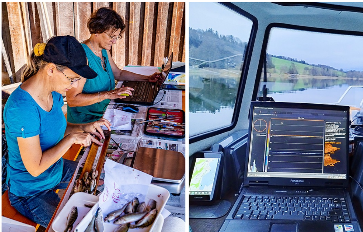
Abbildung 4: Umsetzung der Fischbestandserhebung nach EU-WRRL: Protokollierung des Fanges und hydroakustische Fischbiomasseerhebung (Echolotung; ÖNORM EN 15910), Fotos: ©BAW-IGF.
